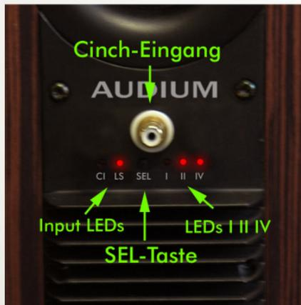
Zur **BassBoost Einstellung** die SEL-Taste zuerst kurz und dann lange gedrückt halten. (kurzer und langer Piepton, CI und LS blinken abwechselnd)
